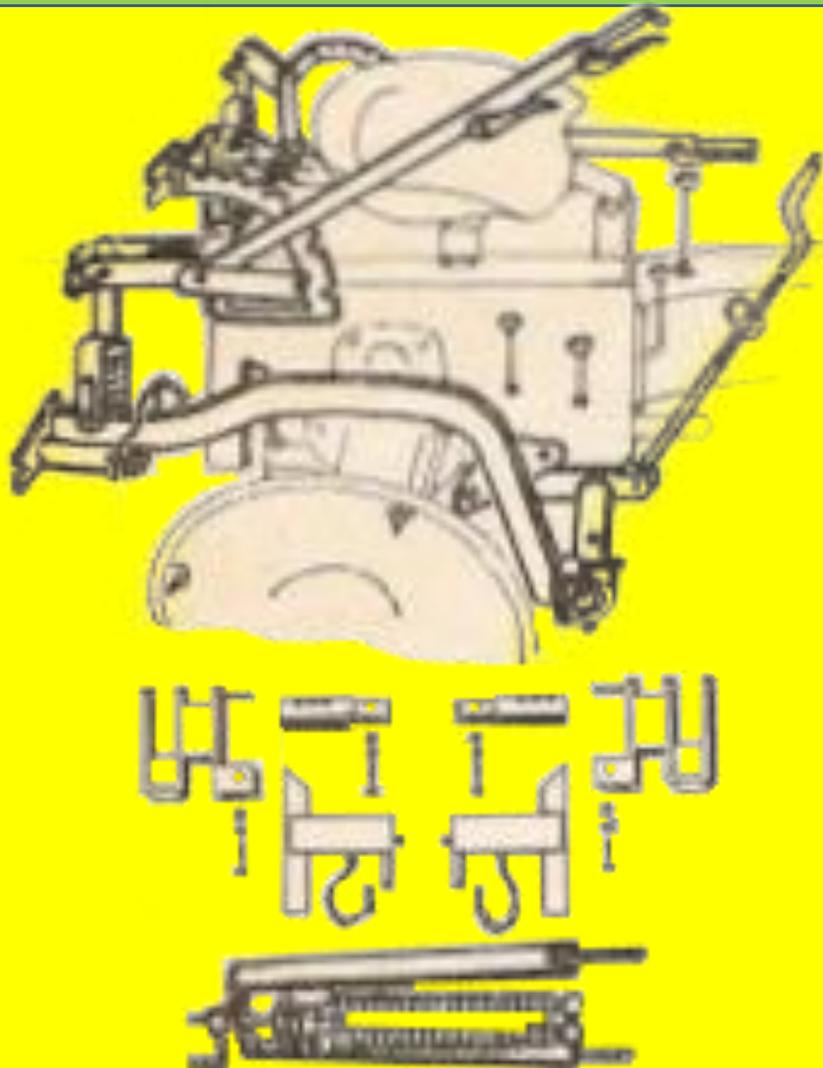
400/3 **HOLDER-Geräte-Aushebevorrichtung** für Handaushebung bestehend aus: 2 Vordergrindeln, Grindellager mit Einstellmöglichkeiten für Pflugarbeitstiefe und Furchenbreite, 2 Grindelansschläge, Aufzugslager mit kompletter Handhebel-Einrichtung. **Normalausführung** für Landwirtschaft. Passend für Schlepper B 12/B und B 12/C bei Normal-Spurweite 1000 mm . . . . .
